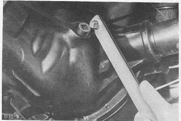
Afb. 5. Verwijderen van de aftapplug, "D" (Salisbury) as.
